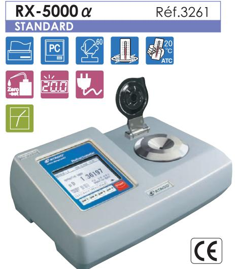
Standard du tout. Le modèle spécial du RX-5000 α permet de pré-programmer une échelle supplémentaire telle que l'humidité du miel, la concentration saline...etc. à la demande du client.
